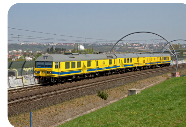
Diagnostické jednotka nedestruktivního měření tratí DJ NDT.
