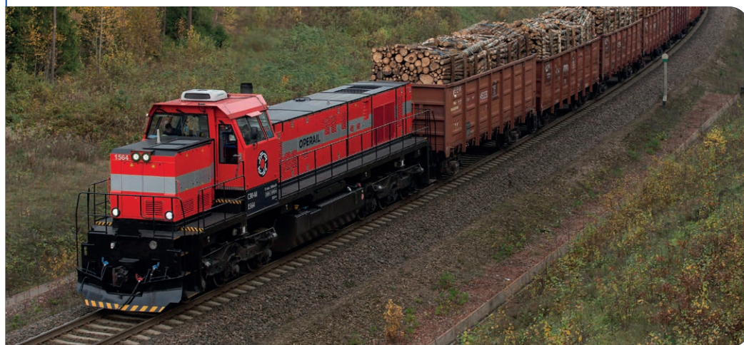
Estonský dopravce Operail využívá pro těžkou traťovou a posunovací službu na tratích o rozchodu 1520 mm typ C30-M. Výroba probíhá v dílnách Operail ve městě Tapa pod dohledem našich specialistů. Typ C30-M vznikl komplexní modernizací amerických lokomotiv GE C30.
