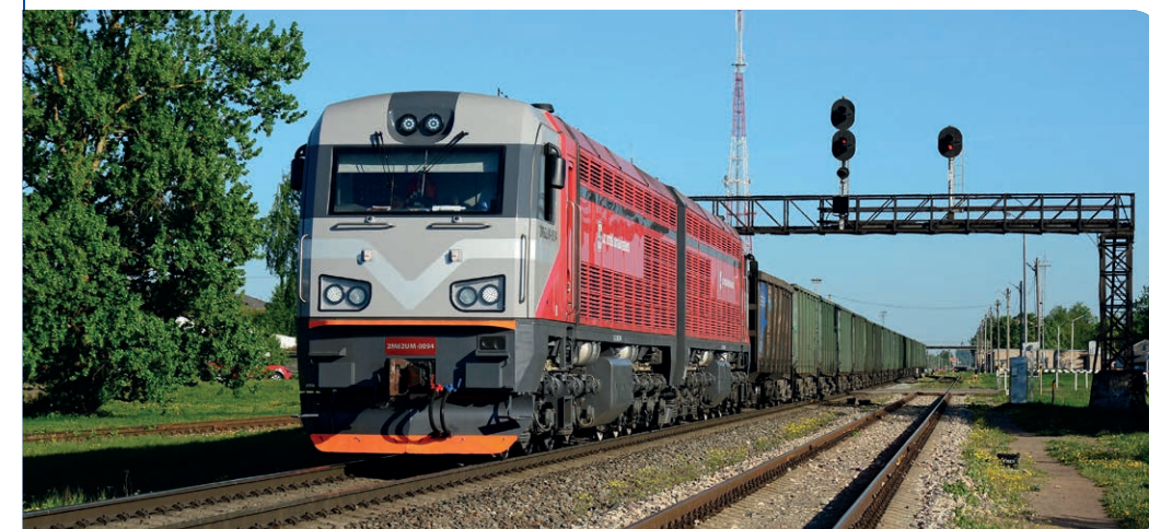
Lotyšským železnicím LDz jsme dodali 14 dvojdielných lokomotiv 2M62UM, které našly uplatnění v těžké nákladní službě. Disponují mohutným výkonem 2x 2 200 kW.
