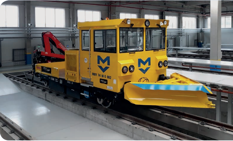
MUUV 74 M-S je vybaveno sněhovým pluhem. Část tratí metra v Sofii totiž vede i mimo tunely po povrchu.
