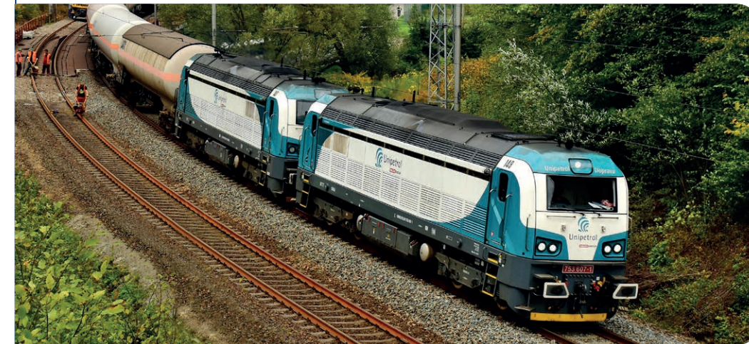
Traťový EffiLiner 1600 navazuje na modernizace „brejlovců“ řady 753.7. Hlavní změnu oproti původnímu provedení představuje nově řešená karoserie, včetně kabin strojvedoucího v elegantním designu CZ LOKO.
