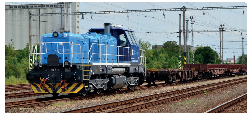
EffiShunter 1000M vznikl na základě poptávky ČD Cargo na modernizaci padesáti starých lokomotiv ČKD řady 742. Pro provoz na koridorových tratích je součástí modernizace i instalace evropského zabezpečovače ETCS.
