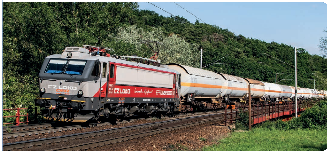
EffiLiner 3000 je dvousystémovou elektrickou lokomotivou určenou pro traťovou službu v České republice, Slovensku a Maďarsku.
