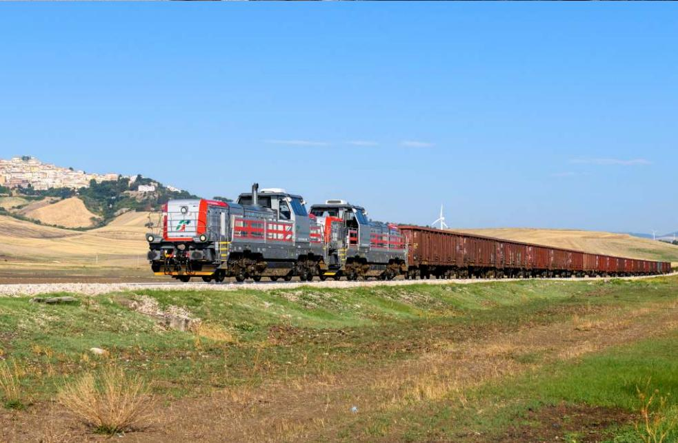
**EffiShunter 1000**, vlajková loď CZ LOKO, je určena jak pro provoz na průmyslových vlečkách v nejnáročnějších podmírkách, tak pro traťovou službu. Pro tyto účely může být vybavena evropským zabezpečovacím systémem ETCS. Schválení dle mezinárodně uznávaného certifikátu TSI zaručuje maximální možnou interoperabilitu v zemích Evropské unie.
