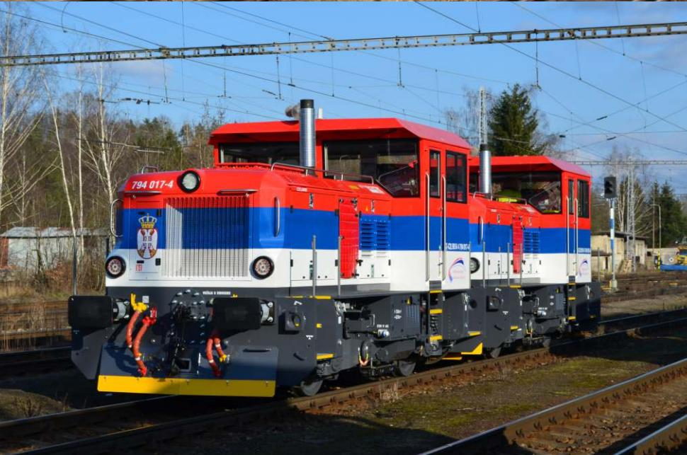
**EffiShunter 300** je moderní dvounápravová lokomotiva vhodná pro lehký posun v depech, na vlečkách a ve stanicích. Dodržení obrysu vozidla pro dráhy speciální navíc umožňuje nasazení v tunelech metra. Jednoduchá konstrukce vozidla byla zvolena s ohledem na co nejnižší pořizovací i následné provozní náklady.
