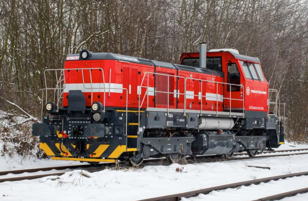
**EffiShunter 600** je vhodný pro středně těžký posun, především na vlečkách. Konstrukce umožňuje nasazení i v náročných podmínkách se zvýšenou okolní teplotou a prašností, které jsou typické pro hutní provozy. Úpravou uložení pojezdu lze dosáhnout průjezdnosti oblouku o minimálním poloměru až 60 m.
