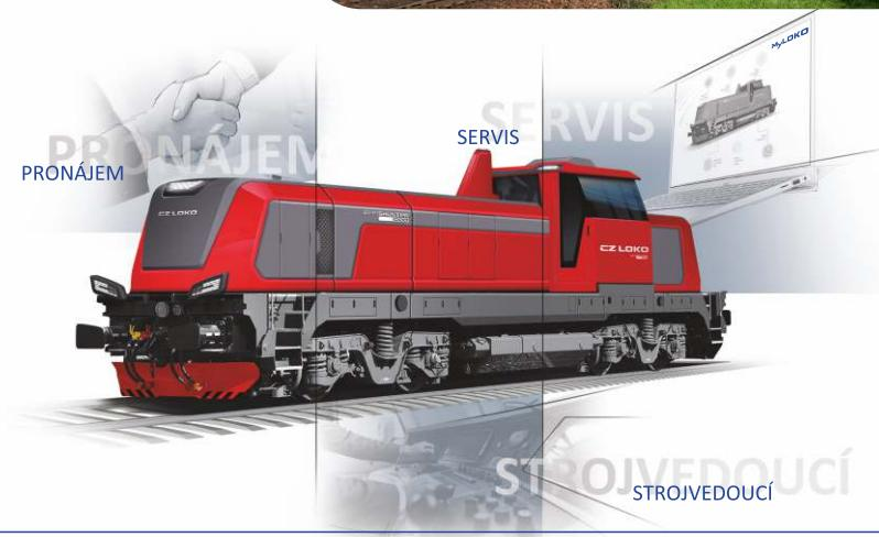
**HydrogenShunter 1000** je další modifikací typu EffiShunter 1000. Jako primární zdroj energie slouží sestava čtyř palivových článků, které jsou doplněny bateriemi. Palivové články zároveň slouží pro dobíjení baterií. Předností tohoto typu je minimální hlučnost a nulové emise v místě provozu vozidla. To ocení provozovatelé především v městských aglomeracích a uzavřených halách.
