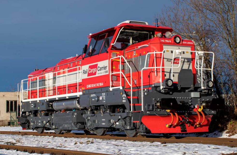
Motorová lokomotiva **EffiShunter 1000M** je určena pro středně těžkou posunovací a traťovou službu na vlečkách a tratích. Je řešena jako kapotová s věžovou kabinou pro strojvedoucího. Hnací agregát tvoří spalovací motor Caterpillar CAT 3508C.
