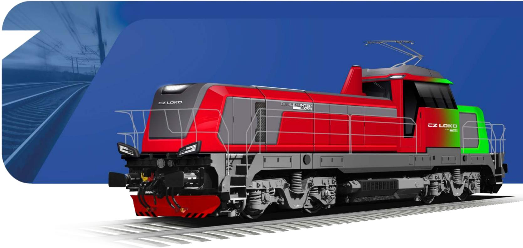
**DualShunter 2000** je lokomotiva určená pro středně těžkou posunovací a traťovou službu na tratích elektrifikovaných systémem 3 kV DC nebo 25 kV, 50 Hz AC, a pro provoz v nezávislé trakci je vybavena spalovacím motorem Caterpillar C32. To umožňuje využívat výhod nezávislé trakce při vozobě nákladních vlaků na elektrifikovaných tratích a zároveň díky dostatečně výkonnému spalovacímu motoru umožňuje bezproblémový provoz na vlečkách a tratích, které elektrifikovány nejsou.
