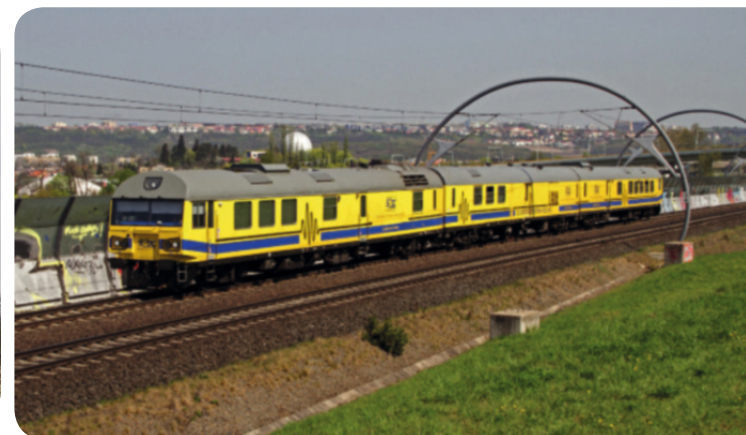
Diagnostická jednotka nedestruktivního měření tratí.
